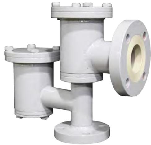
La válvula de presión y vacío, modelo PA, está diseñada para utilizarse en ventilación de recipientes presurizados, donde se requiere la hermeticidad del mismo cuando no entra o sale producto y estabiliza la presión interior tanto positiva como negativa a los rangos de apertura que está calibrada la válvula (pre-dimensionados de acuerdo al diseño del tanque).
