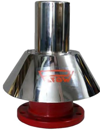
Esta válvula de alivio de presión, modelo RPS, se utiliza en recipientes donde se desea presurizar su contenido hasta un determinado rango, al cual la válvula se abre y libera el exceso evitando que el tanque se deforme.
