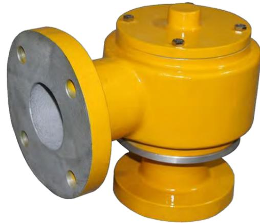
Esta válvula de alivio de presión, modelo RP, se utiliza en recipientes donde se desea presurizar su contenido hasta un determinado rango, al cual la válvula abre y libera el exceso evitando que el tanque se deforme.
