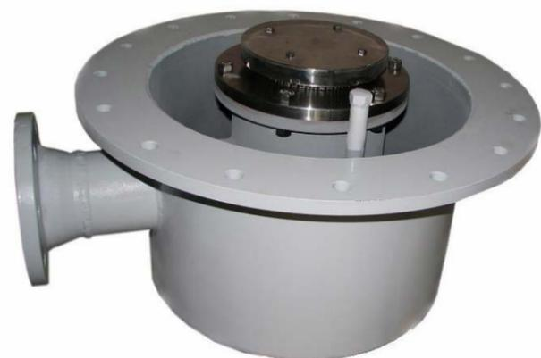
Esta válvula cuenta con un sistema que deja ingresar el agua pluvial pero bloquea el orificio de conexión al ambiente, cuando se rompe un sello o una cañería del drenaje. Se provee standard construida en acero al carbono con interiores en acero inoxidable aptos para el trabajo en recipientes de aceite, agua, hidrocarburos, etc.
