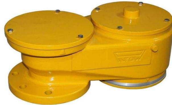
La válvula de alivio de vacío, modelo **RV** se utiliza en recipientes donde es necesario aliviar su depresión o vacío para evitar deformaciones en su estructura. Su aplicación es variada, como ejemplos podemos citar: alivio de vacío en tanques presurizados con un vaciado rápido, alivio de recipientes calefaccionados con una emergencia de corte de suministro de calor o vapor, lavado de tanques con vapor o agua caliente para luego aplicar agua fría donde el aire se condensa bruscamente, etc.
