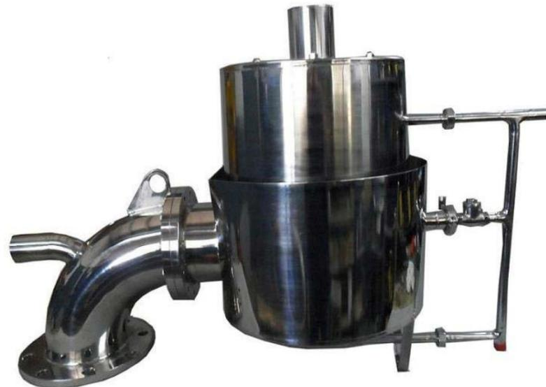
La válvula de presión y vacío, modelo **TRD** se utiliza en recipientes donde es necesario aliviar su presión o vacío para evitar deformaciones en su estructura.
