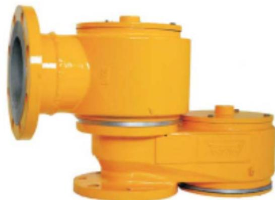
La válvula de presión y vacío, modelo PA, está diseñada para utilizarse en ventilación de recipientes presurizados, donde se requiere la hermeticidad del mismo cuando no entra o sale producto y estabiliza la presión interior tanto positiva como negativa a los rangos de apertura que está calibrada la válvula (pre-dimensionados de acuerdo al diseño del tanque).
