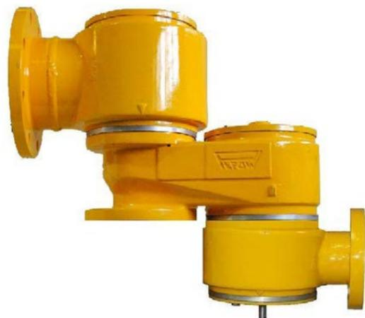
Existen productos que por su tipo o su composición, no pueden estar en contacto con la atmósfera ya que son alterados químicamente por los componentes del aire. En estas ocasiones, se pueden utilizar como venteo válvulas con inyección de gas (nitrógeno o gas natural) o aspiración de aire a través de un filtro (eliminador de humedad, polvo, etc.), creando dentro del tanque una atmósfera sobre el producto almacenado, evitando la contaminación del mismo.
